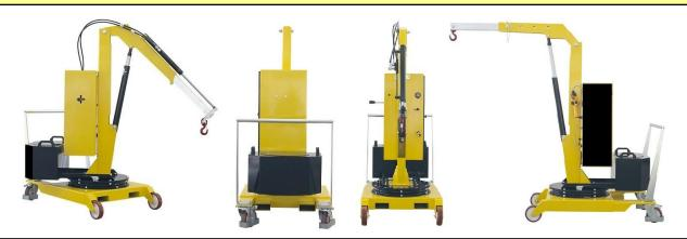
Una completa gamma di gru contrappesate a trazione manuale, girevoli 360°, con portata massima fino a 500 Kg e sbalzo libero fino a 1300 mm. Azionamento con pompa a mano o elettrico regolabile.
