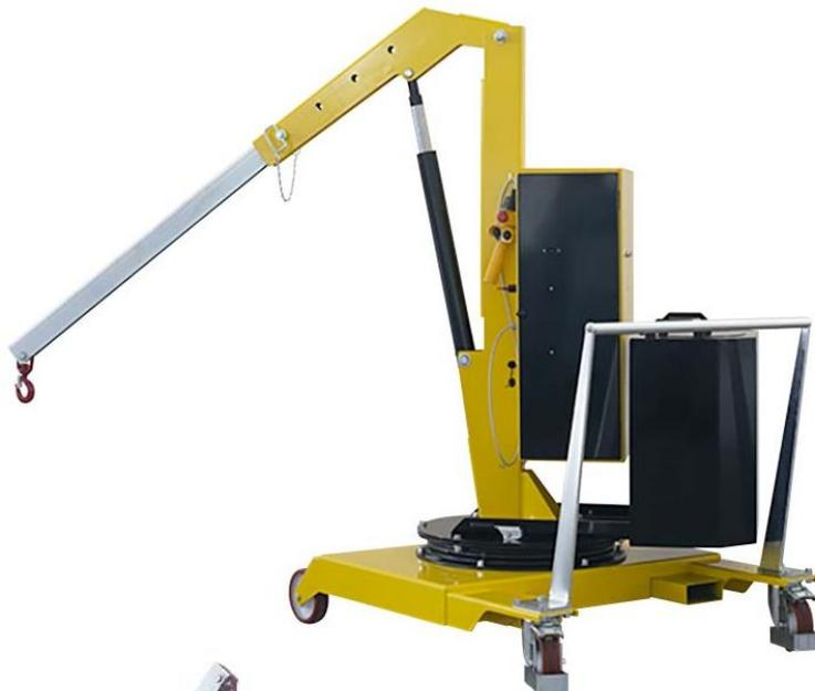
La 01B5 è equipaggiata con pulsantiera pensile per la salita e la discesa elettrica a singola velocità.
