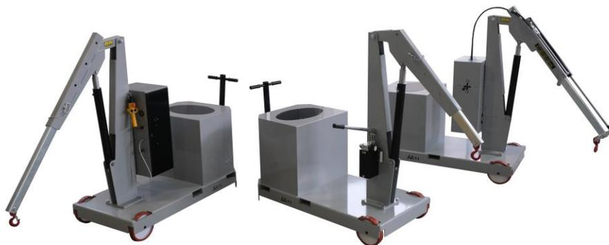
Una completa gamma di gru contrappesate a trazione manuale, **con portata massima fino a 1000 Kg e sbalzo libero fino a 2000 mm**. Azionamento con pompa a mano o elettrico regolabile.
