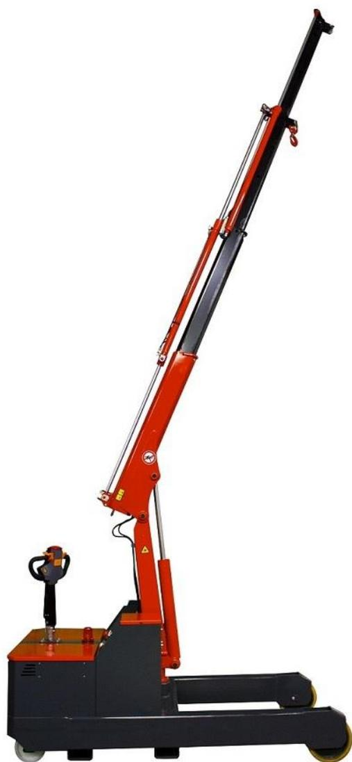
La OMNIA 2TL/2TR è una gru full electric Pick & Carry con portata massima 2000 Kg e con triplo sfillo elettrico che raggiunge uno sbalzo libero da battuta di oltre 3 metri
